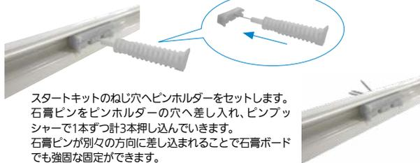
スタートキットのねじ穴へピンホルダーをセットします。石膏ピンをピンホルダーの穴へ差し入れ、ピンブッシュャーで1本ずつ計3本押し込んでいきます。石膏ピンが別々の方向に差し込まれることで石膏ボードでも強固な固定ができます。
