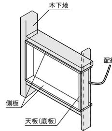
リモコンボックスを横向きに取り付ける場合は配線と木下地にご注意ください。配線避けるために天板(底板)が側板の奥行きより短くなっています。
