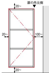
開戸を取り付ける場合の天井・壁・床との離隔距離は上図のようになります。(寝室プラン)
