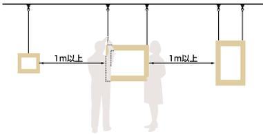
■ レール強度、フック・ワイヤ各1個(本)の推奨荷重が30kgであれば60kgの作品を2本のワイヤで吊るすことが可能だと考えられます。しかし、展示作業中、片方の作業者が手を滑らせたり、場合によっては片方ずつ吊るすような作業も考えられます。このような場合、片方のワイヤに全荷重がかかることになり事故の原因となります。
