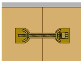
カウンター裏面にざぐり加工をし、連結金具を仮締めをしてください。
