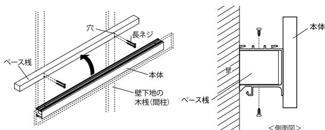
ベース棧正面の穴に長ネジを合わせて、壁面に取り付けます。
