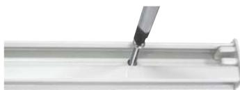
付属の木用ねじで固定します。(ねじ穴はあらかじめ空いています)。木部(下地)へのねじの締め付けは大変な力を有します。事前にキリなどで下穴を空けておくとなねじの入りが良く便利です。
