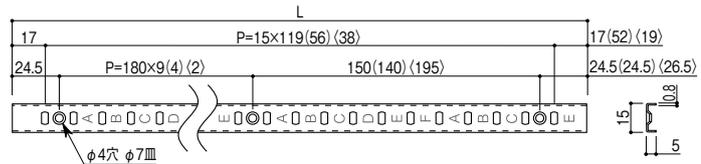
※( )の寸法はL909mm、( )の寸法はL606mmの寸法です。
