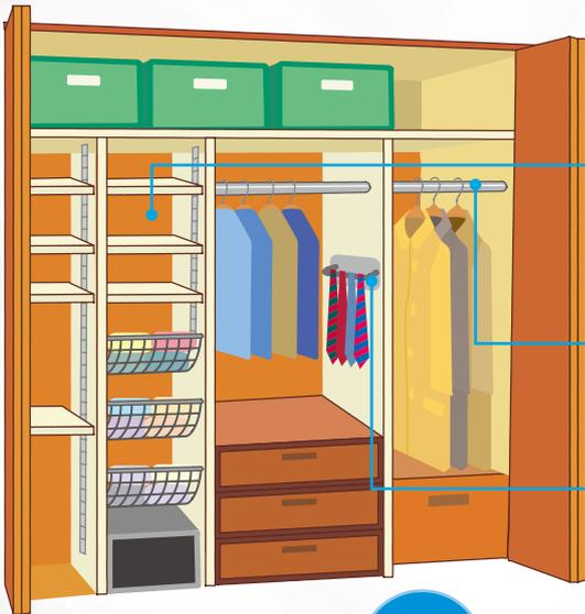
棚柱を利用して可動式の棚を設置。
