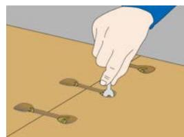
カウンター表面のレベル・前ダレのレベルを調整してから本締めしてください。
