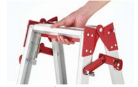
ワンタッチバー バーを持ち上げると開き止めを解除。 片手で簡単に閉じることが可能に。
