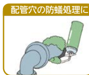
※木部は蟻道の影響を受けるため、土台の木部防蟻処理は必ず行ってください。
